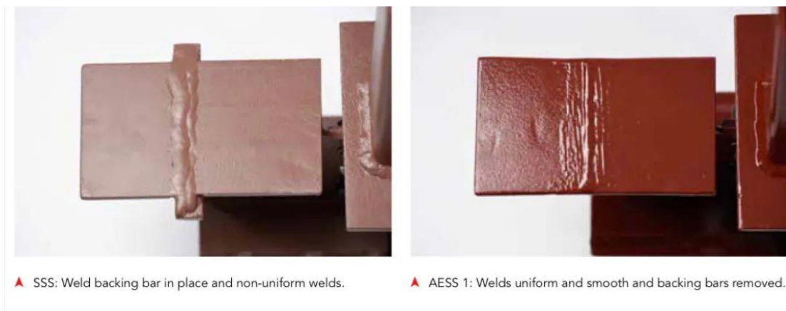
图 4 是否为 AESS 构件打磨效果对比
