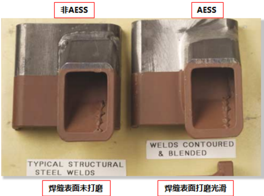
图 3 是否为 AESS 构件焊缝效果对比
